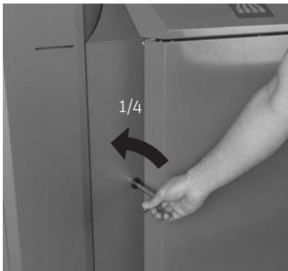
Fig. 5 Ouverture de la porte du revêtement à l'aide d'une clé mâle coudée pour vis à six pans creux
