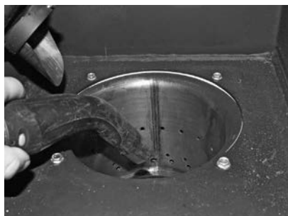
Fig. 104 Aspirer le creuset du brûleur
