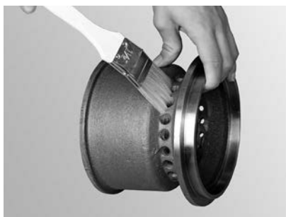
Fig. 102 Nettoyer le cône
