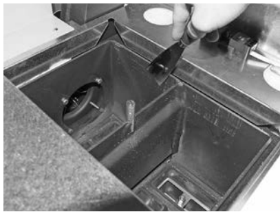
Fig. 117 Nettoyer les surfaces d'échange
