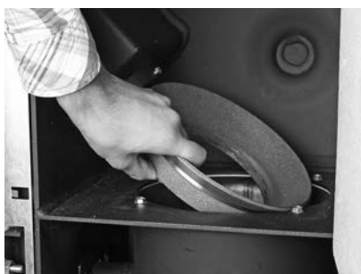
Fig. 100 Retirer le cône de partie supérieure
