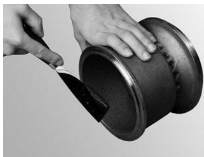
Fig. 103 Nettoyer le cône
