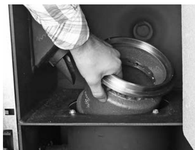
Fig. 101 Retirer le cône de partie inférieure
