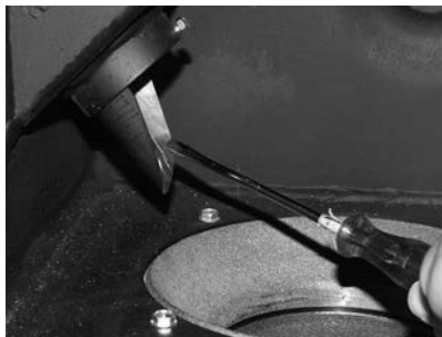
Fig. 98 Nettoyer la gouttière
