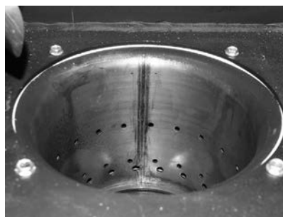
Fig. 107 Nettoyer les volets d'air secondaire dans le creuset du brûleur
