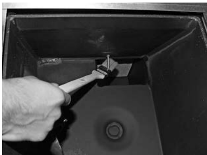
Fig. 97 Nettoyage de la sonde Thermocontrol
